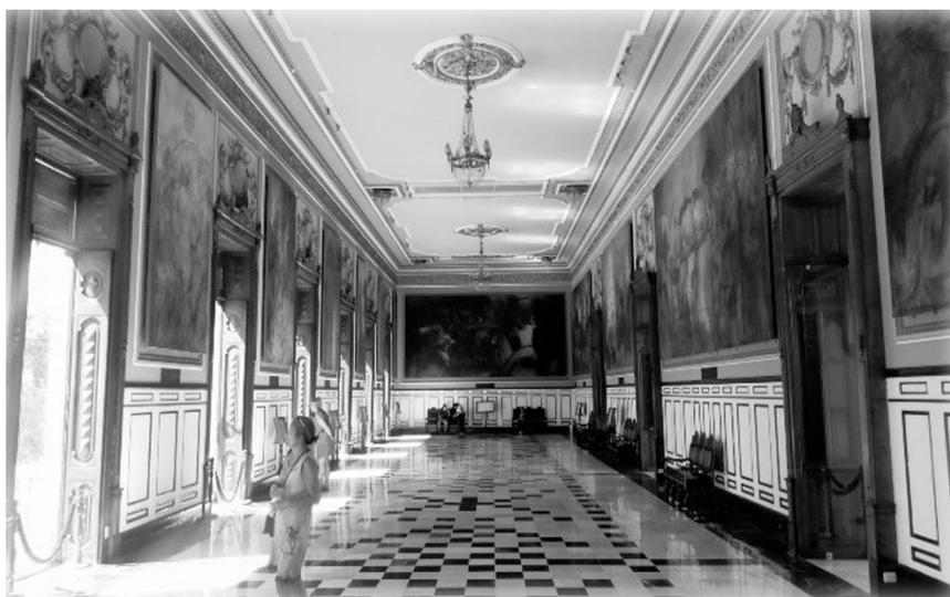
FIGURA 1. Vista de uno de los salones de planta alta con techumbres de vigería metálica y *bahpek* colocado al nivel bajo para lograr el plafón liso. Foto del autor, 2017.
