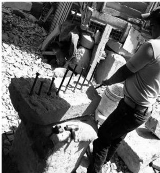
FIGURA 9. La actividad de “cuñear la piedra” implica colocar cuñas o cinceles con una separación de 10 cm y golpear cada uno de ellos, separando los bloques de una manera lineal.
