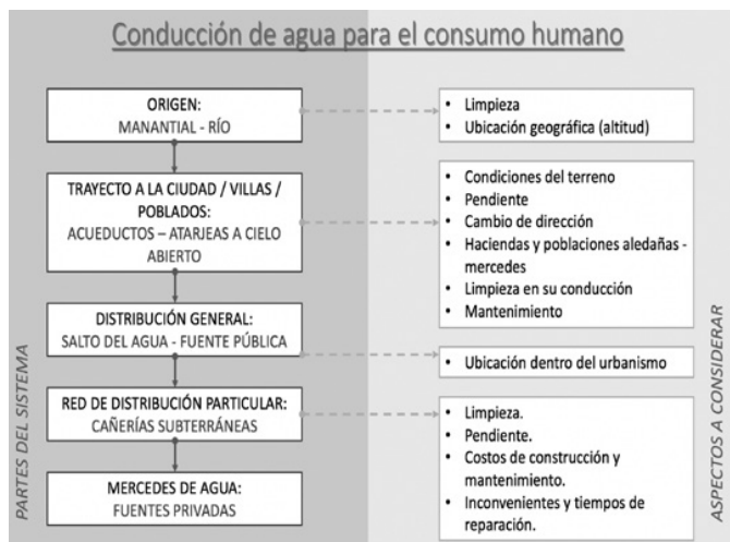
FIGURA 1. Propuesta del sistema y sus partes que conforman la infraestructura hidráulica virreinal de abastecimiento de agua potable. Elaboración: Martha Elena Ortiz Sánchez, 2020.
