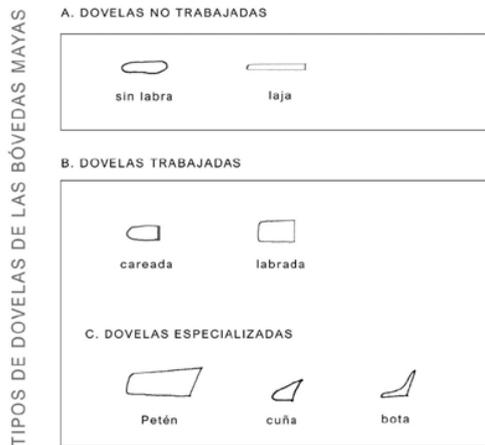
FIGURA 7. Clasificación de los tipos de dovelas de piedra según el grado de labra y de especialización. Elaboración propia.
