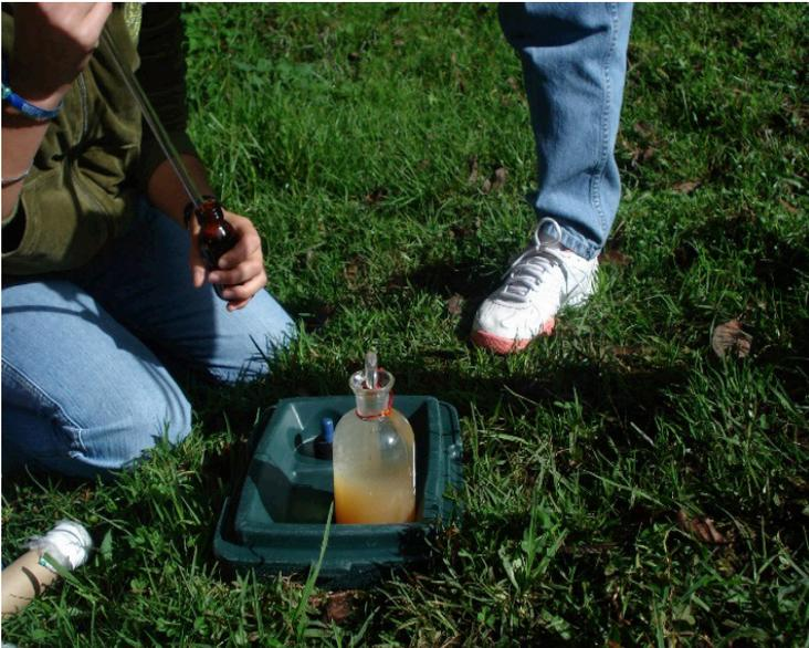
Figura 32. Colecta de muestras, medición de concentración de oxígeno disuelto con el método Winkler. Fotografías: Barrera Bernal, 2009.
