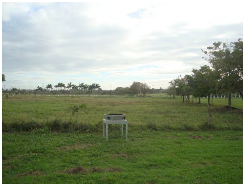
Figura 2.24. Sodar utilizado en la campaña de mediciones del 13 al 23 de diciembre de 2014.
