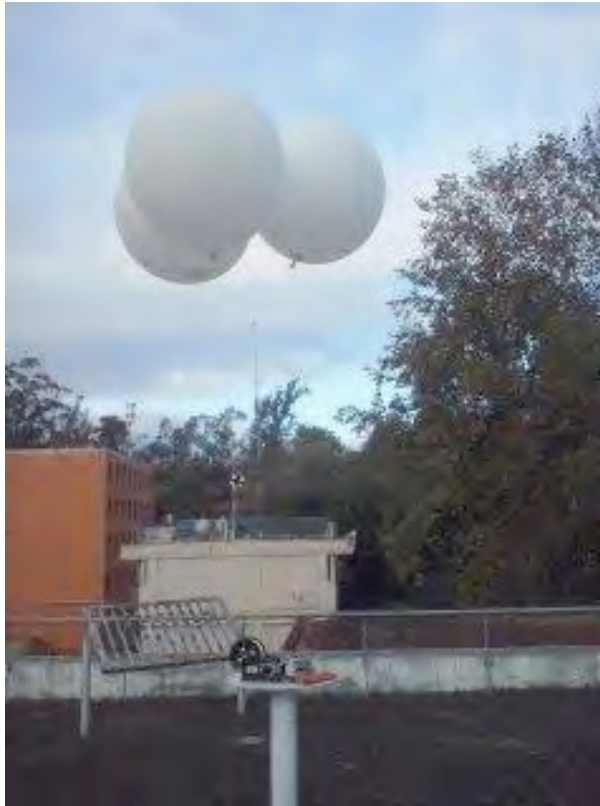
Figura 2.20. Sistema de globos cautivos usado para la obtención de perfiles de temperatura y humedad relativa.
