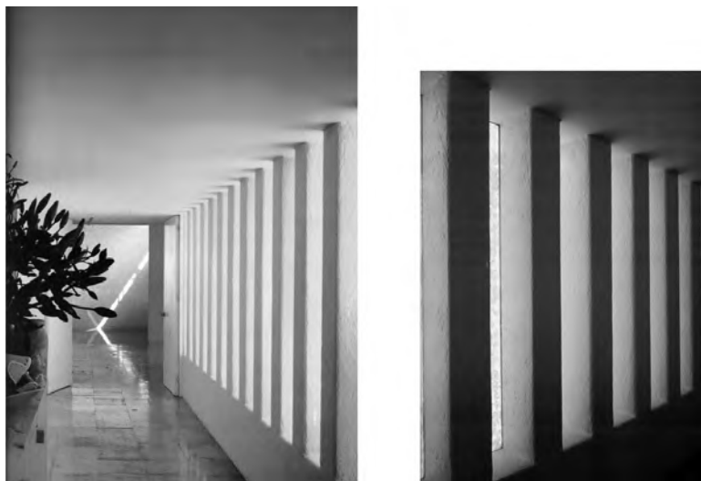
Figura 25. Sensación de amarillez –pasillo pintado de luz amarilla de la Casa Gilardi– lograda por Luis Barragán gracias al empleo de dos estímulos físicos concretos: ventanas amarillas orientadas hacia el sol y muros y plafón pintados de blanco.
