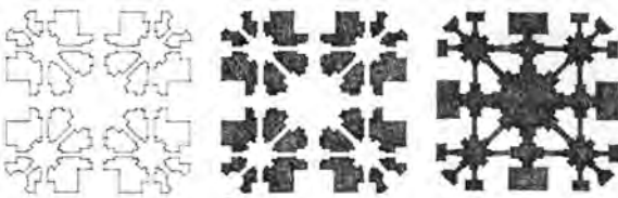
Figura 4. Esquema de Ching que presenta, en tres esquemas, la planta del Taj Mahal. Delineada en negro, la masa constructiva; en negro, el espacio que la forma delimita.
