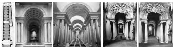
Figura 79. Pasillos de perspectiva forzada para acentuar su profundidad. Galería del Palacio Spada, de Borromini (planta y dos imágenes); y Scala Regia en el Vaticano, de Bernini.
