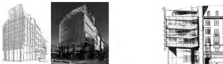
Figura 46. Perspectiva y obra construida que, en el caso de la fachada corta y pese a las deformaciones registradas por el ojo, el cerebro sabe que son rectángulos, como puede apreciarse en el geometral de la derecha.
