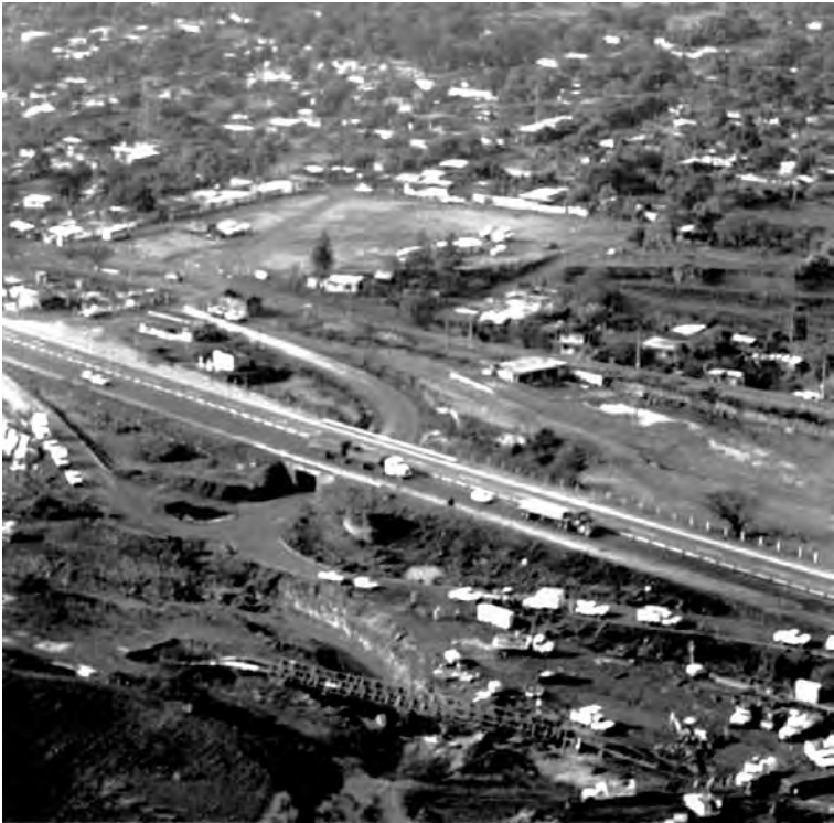
Figura 38. Imagen aérea en la que se observa el impacto del flujo de lodo y detritos sobre los ductos de Pemex, en la localidad de Balasterra, municipio de Ciudad Mendoza (fotografía S. Rodríguez).
