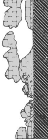
Figura 40. Gráfica descriptiva de la evolución del fenómeno de disolución en rocas calcáreas.
