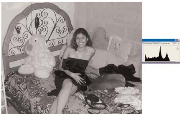
Fig. 15. Imagen digital y su histograma de intensidades. En el eje horizontal se representa la intensidad de la imagen. El eje vertical representa la frecuencia de cada intensidad.
